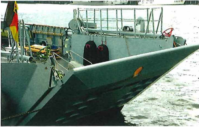
Details der Bugrampe auf LACHS im Juni 2009 bei der Kieler Woche. Gut sehen kann man die Dorndurchführung mit der man die Rampe am Heck eines anderen Landungsbootes einhakt zur Herstellung einer Fahrzeugbrücke. Die Fahrzeuge können dann von einem zum anderen Boot bis zum Strand fahren. Die Rampe hat ein Gewicht von 4.200kg. Martin Rode
