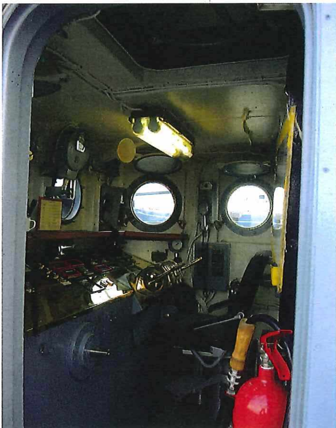
Unterer Steuerstand auf SCHLEI. Steuerrad ist abgenommen. Zu erkennen ist der Maschinentelegraf zur getrennten Bedienung der zwei Dieselmotoren. Olaf Rahardt
